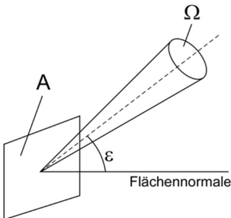
Abb. 2 Strahldichte L unter einem Winkel  $\varepsilon$
